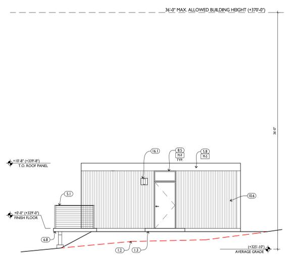
2 AHU - EAST ELEVATION
